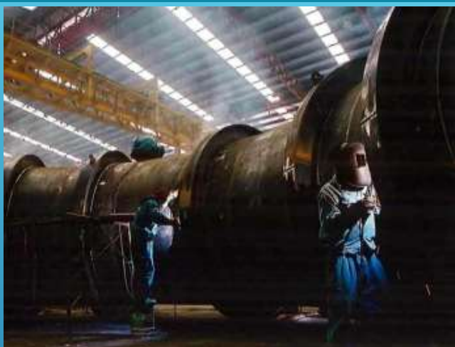
Chế tạo ống tuần hoàn chính Thủy điện Đắk Glun / Fabrication Main Circulating Water Piping for Đắk Glun Hydropower Plant
