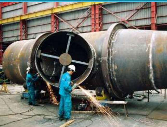
Chế tạo ống tuần hoàn chính Thủy điện Đắk Glun / Fabrication Main Circulating Water Piping for Đắk Glun Hydropower Plant
